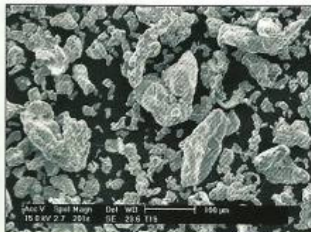
Figura 2 - Micrografia do pó aço rápido AISI T15 [7]
